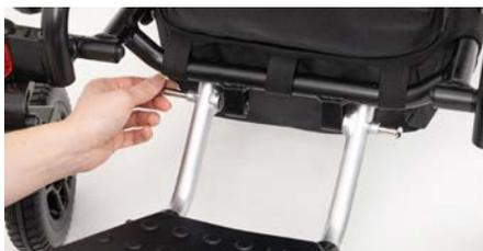
Figure 5 : Mise en place des vis écrous
