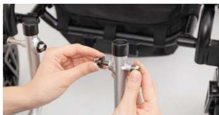
Figure 4 : Démontage de l'ensemble de vis écrou
