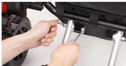
Figure 6 : Serrage de la vis écrou
