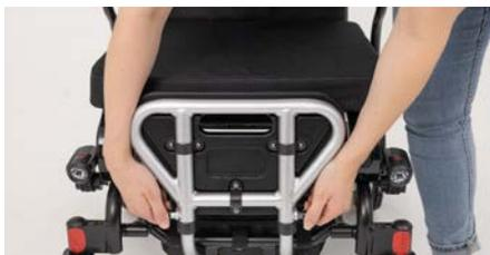
Figure 7 : Tirez sur les doigts d'indexage
