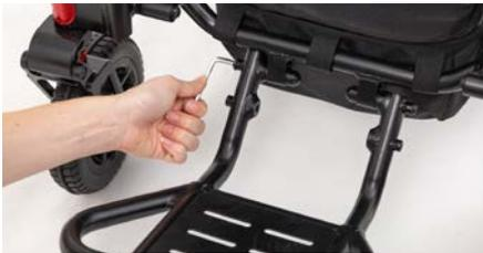
Abbildung 1: Lösen der Schrauben
