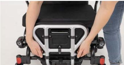
Abbildung 7: Ziehen der Rastbolzen
