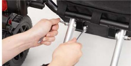
Abbildung 6: Festziehen der Schraube
